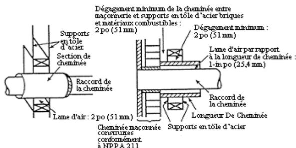
A En brique maçonnées ayant une épaisseur minimale de 3,5 po entièrement encastrée dans le mur avec un cadre et ayant une séparation minimale de 12 po par des briques entre le boisseau en argile et les matériaux combustibles. Le boisseau en argile doit aller de la surface extérieure du mur en briques jusqu'à la surface intérieure de la gaine de la cheminée; il doit être cimenté fermement en place.
